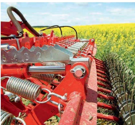
Der Zinkendruck lässt sich von der Fahrerkabine aus hydraulisch verstellen.
